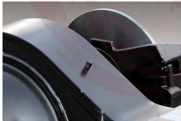
• Пылезащищенное вентиляционное отверстие переднего моста
