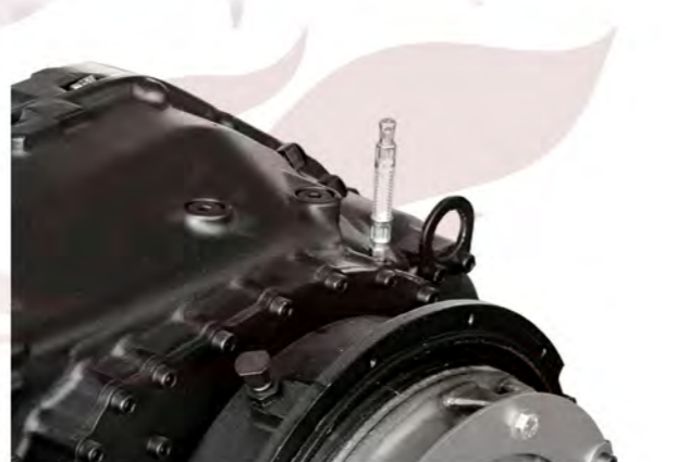
• Пылезащищенное вентиляционное отверстие коробки передач
