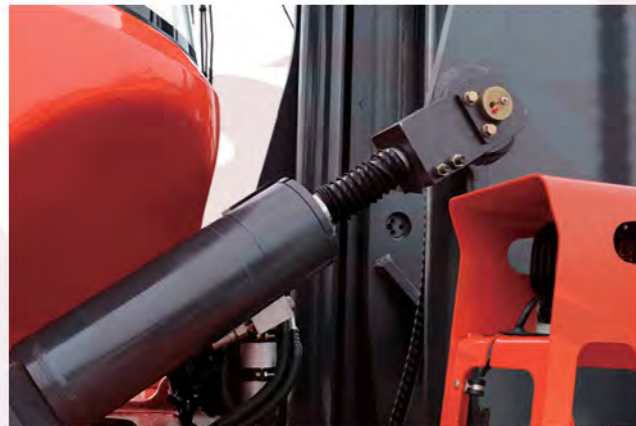
• Защитная муфта гидравлического цилиндра (дополнительно): служит для защиты цилиндра от повреждения инородными объектами
